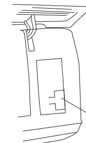
Кнопка вкл./выкл. автоматического режима
