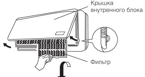
1. Поднимите крышку лицевой панели двумя руками в направлении на себя и вверх.
