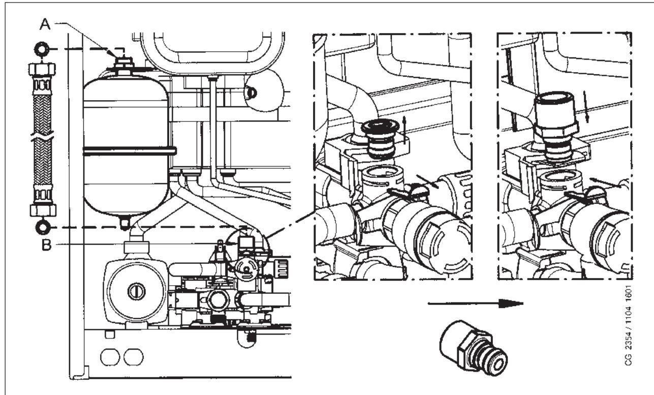
Connecter le tuyau flexible (fourni comme accessoire dans kit vase d'expansion) sur les deux raccords A et B, comme indiqué à la figure. Le montage du vase d'expansion sanitaire est recommandé dans les cas suivants :
