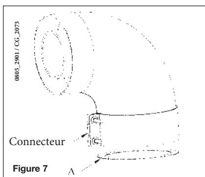
L'extrémité du conduit ressort à l'extérieur du bâtiment et doit dépasser la maçonnerie pour permettre l'installation de la rosace en aluminium et de son scellement et éviter toute infiltration d'eau. La pente minimum vers l'extérieur de ces conduits doit être de 1 cm par mètre de longueur.
