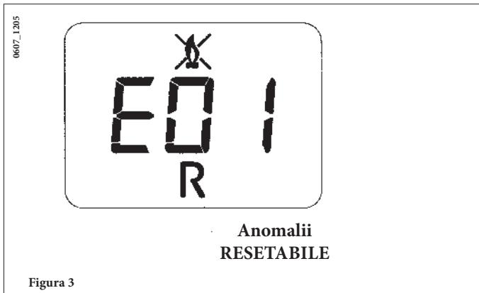
Pentru RESETAREA centralei, apăsați pentru cel puțin 2 secunde tasta "R". În caz de intrare în funcțiune repetată a acestui dispozitiv, adresați-vă Centrului de Asistență Tehnică autorizat.
