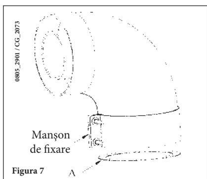
În caz de evacuare la exterior, conducta de evacuare-admisie trebuie să iasă din perete cu cel puțin 18 mm pentru a permite poziționarea și sigilarea tiglei de protecție din aluminiu, în vederea evitării infiltrărilor de apă. Asigurați o pantă minimă, spre exterior, de 1 cm pentru fiecare metru de lungime.
