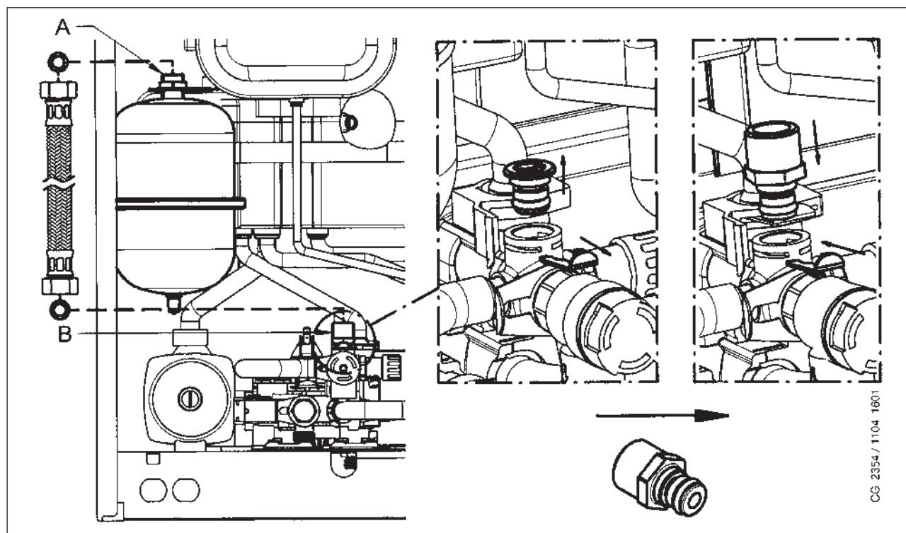
Podłączyć wąż (dostarczony w komplecie zbiornika wyrównawczego) do dwóch złączy A i B w sposób zilustrowany na rysunku. Montaż zbiornika wyrównawczego c.w.u. jest zalecany w przypadku, gdy:
