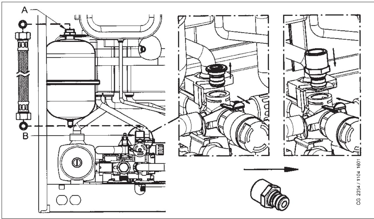
如图，将软管（在膨胀罐套件中有提供）连接到A和B两个接头上。
