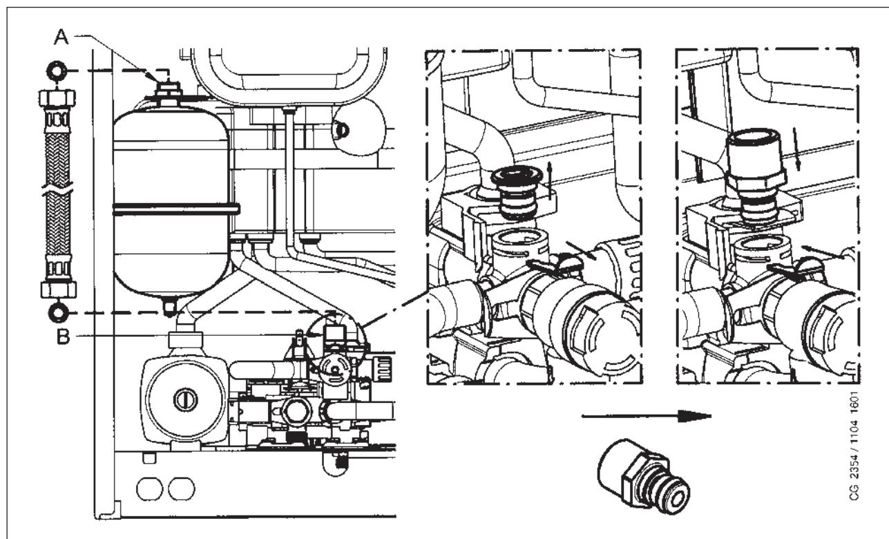
Collegare il tubo flessibile (fornito come accessorio nel kit vaso espansione) sui due raccordi A e B come illustrato in figura. Il montaggio del vaso di espansione sanitario è consigliato nei casi in cui:
