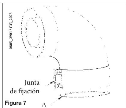
Si la salida de gases se encuentra en el exterior, el conducto de descarga-aspiración debe sobresalir 18 mm como mínimo de la pared para que la cubierta de tejas de aluminio pueda fijarse y sellarse con el fin de evitar fugas de agua. La inclinación mínima hacia afuera de estos conductos debe ser 1 cm por metro de longitud.
