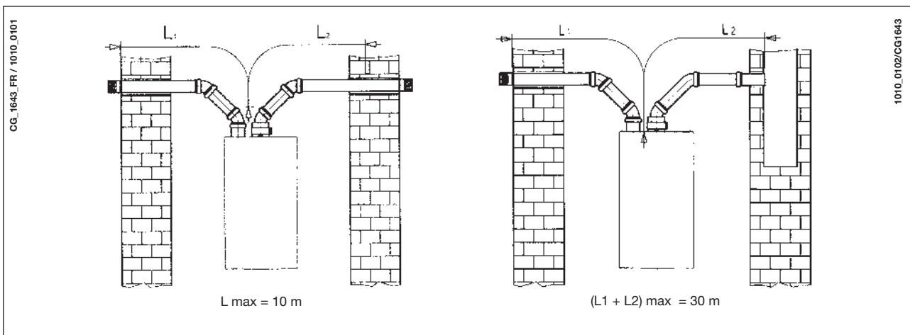
**N.B.:** Para los tipos C52 los terminales para la aspiración del aire comburente y la descarga de los productos de la combustión no se deben situar en las paredes opuestas al edificio.
