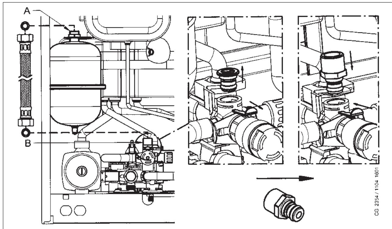
Свържете гъвкавата тръба (аксесоар от комплекта разширителен съд) към двете муфи А и В както е показано на фигура. Монтажа на разширителен съд за битовата вода се препоръчва в следните случаи:
