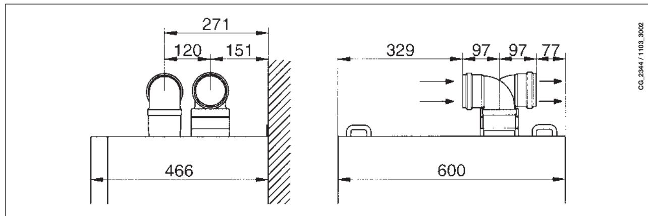
**IMPORTANT:** pour les installations à un seul conduit, s'assurer que le conduit est bien isolé (par ex. avec de la laine de verre) là où il doit traverser un mur.
