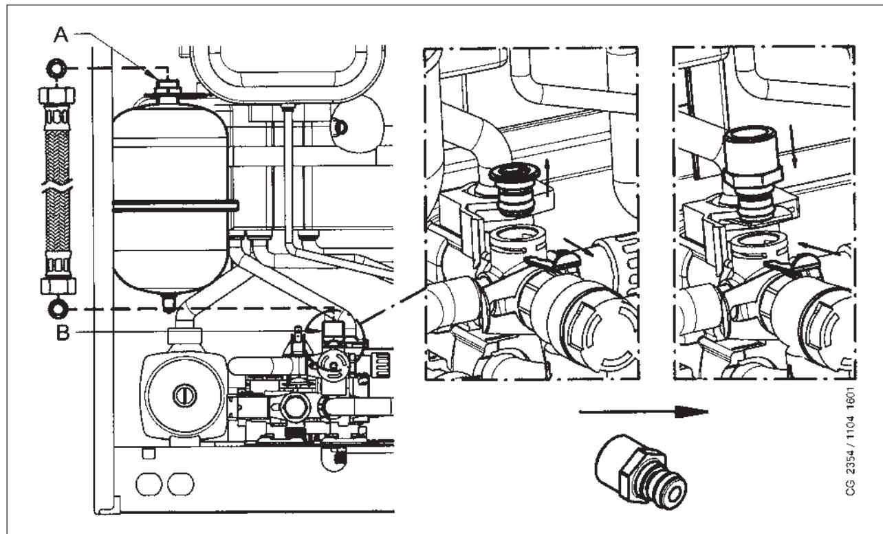
Conectar el tubo flexible (suministrado como accesorio en el kit depósito de expansión) a las dos uniones A y B según se indica en la figura. La instalación del depósito de expansión ACS se aconseja en los siguientes casos:
