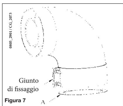
In caso di scarico all'esterno il condotto scarico-aspirazione deve fuoriuscire dalla parete per almeno 18 mm per permettere il posizionamento del rosone in alluminio e la sua sigillatura onde evitare le infiltrazioni d'acqua.
