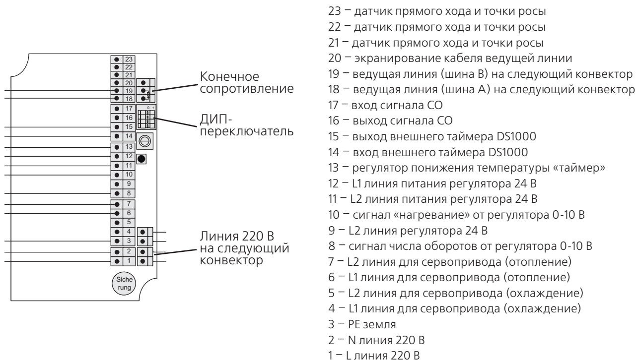
Рис. 1.12. Многофункциональный блок управления воздуходувкой GS1000
