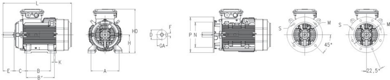
Электродвигатель, монтируемый на лапах IM1001, В3 и электродвигатель, монтируемый на фланце IM3001, В5
