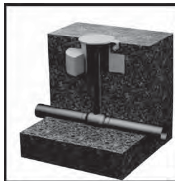
Подземный кран, установка под ковер
