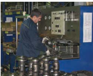
Тестирование шаровых кранов
