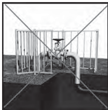
Наземная установка задвижки
