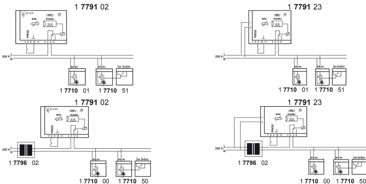
Количество приводов которое можно подключить к регулирующему устройству
