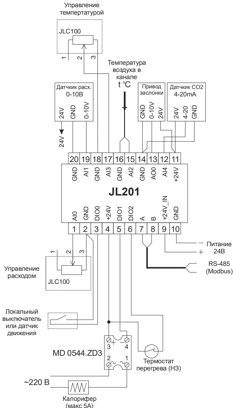
**Рисунок 5 - Типовая схема подключения модуля JL201 для VAV-систем**
