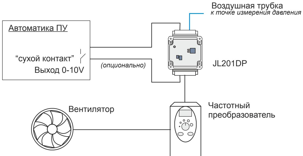
Рисунок 9 - Регулирование давления
