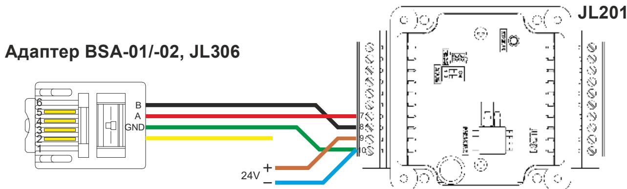
Рисунок 3 - Подключение JL201 к адаптерам с разъёмом RJ-14
