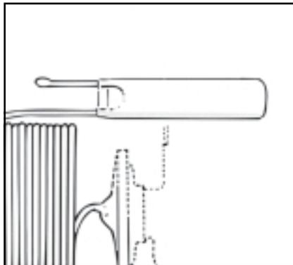
**При заправке МОР с наполнителем** внутри капсулы содержится материал с высокой пористостью, т.е. с большим отношением поверхности к массе. Этот наполнитель создает демпфирующий эффект при регулировке, обеспечиваемой TRV: медленное открытие клапана во время повышения температуры капсулы и быстрое закрытие при понижении. МОР обычно переводят также как «Motor Overload Protection», т.е. «Защита двигателя от перегрузки».
