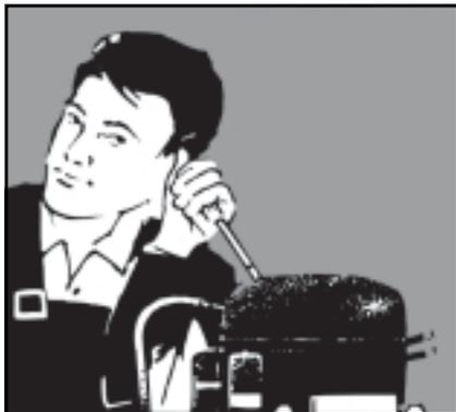
Шум в системе является неприятным фактом для домашних холодильников. Здесь характерно появление шума при входе жидкости в испаритель. От этой проблемы трудно избавиться, поскольку все детали являются предметами массового производства. Если фильтр установлен вертикально, возможно, сможет помочь установка его горизонтально.
