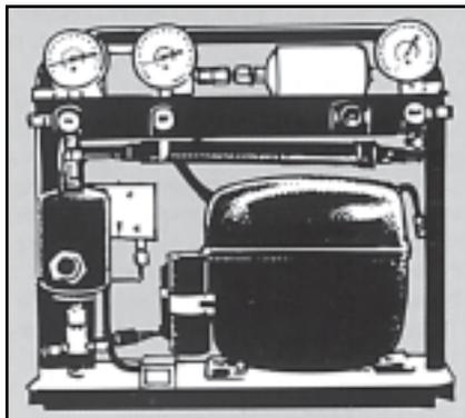
После этого можно заменять ТРВ и влагоотделитель, установив приборы нужного размера с маркировкой «R134a».
