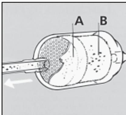
Фильтры типа DN 032s, DN 032,5s и DN 033s изготовлены специально для систем с капиллярной трубкой и поэтому применяются в холодильных установках с испарением через капилляр.
