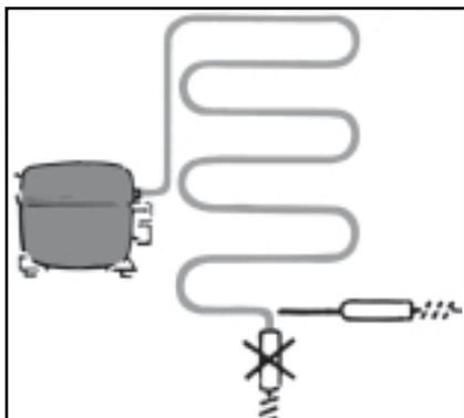
Чтобы исключить передачу вибрации, трубопроводы холодильной системы не должны касаться компрессора, теплообменника или боковых стенок.
