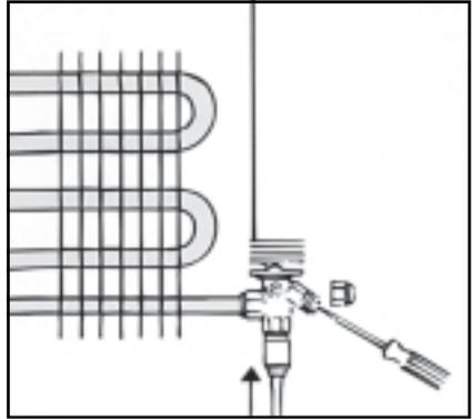
Начиная с ТЕ5, полный оборот винта дает температуру перегрева около  $0,5^{\circ}\text{K}$  при температуре испарения  $0^{\circ}\text{C}$ . Начиная с ТКЕ3, полный оборот винта дает изменение перегрева примерно на  $3^{\circ}$  при температуре испарения  $0^{\circ}\text{C}$ .
