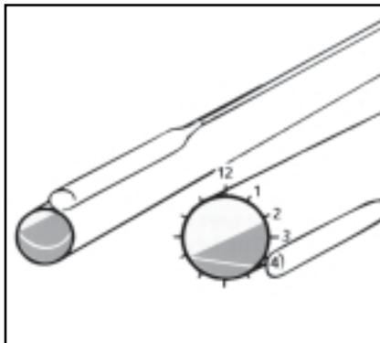
Капсула должна контролировать температуру перегретого пара на линии всасывания, поэтому устанавливать ее нужно таким образом, чтобы избежать влияния на нее посторонних источников тепла или холода. Если есть опасность попадания на капсулу потока горячего воздуха, ее нужно теплоизолировать.
