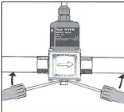
Для промывки клапанов WVFX вставьте две отвертки в щель с каждой стороны регулировочного узла под основание пружины и отожмите их книзу (к трубам), чтобы увеличить отверстие для прохода воды.
