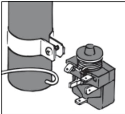
В системах с терморегулирующим вентилем объем заправки должен контролироваться с помощью смотрового стекла. Как в том, так и в другом случае объем хладагента в системе должен быть меньше свободного объема магистралей со стороны линии нагнетания. Устройство РТС (25 Ом для сетевого напряжения 220 В и 6,5 Ом для напряжения 115 В) можно проверить с помощью омметра.
