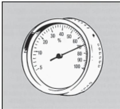
Проверка волосного гигрометра осуществляется обмоткой корпуса чистой влажной тканью, а затем гигрометр помещается в герметичный контейнер с водой на дне, при этом вода не должна попадать в гигрометр и его капсулу.
