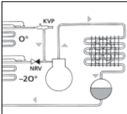
В установках с запараллеленными испарителями и общим компрессором регулятор KVP устанавливают во всасывающей магистрали, чтобы поддерживать в испарителях одинаковое давление.
