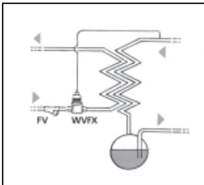
Клапаны WVFM и WVFХ 32-40 устанавливаются таким образом, чтобы корпус сильфона был наверху.
