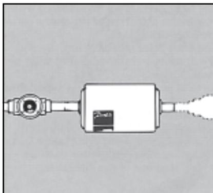
Таким образом, индикация как полного количества влаги в холодильной системе, так и состояния хладагента перед расширительным клапаном может быть определена при условии, что смотровые стекла установлены по обе стороны фильтра-осушителя. Точка перехода от зеленого цвета к желтому на индикаторном смотровом стекле определяет степень поглощения влаги хладагентом. Индикатор становится желтым перед тем, как возрастает риск замерзания воды в ТРВ
