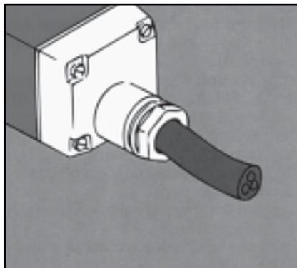
Определите значение цвета проводов. Желтый/зеленый цвет всегда обозначают цепь заземления.
