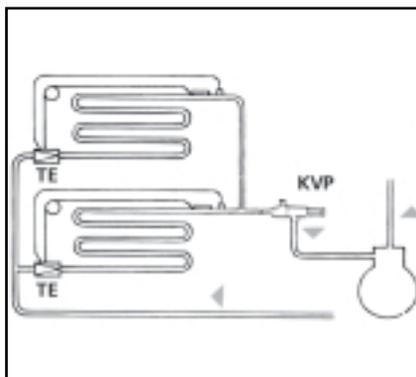
Регулятор давления испарения снабжен манометрическим отводом, который служит для настройки давления испарения.
