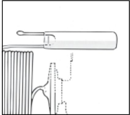
**ТРВ с заправкой МОР** используются в моноблочных агрегатах, в которых при запуске желательно ограничивать давление всасывания (авторефрижераторы, воздушные кондиционеры).
