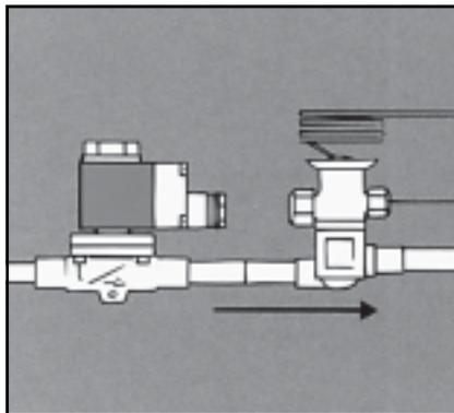
Если гидроудар происходит при закрывании соленоидного клапана, то его можно компенсировать установкой вертикальной Т-образной трубки перед соленоидным клапаном.
