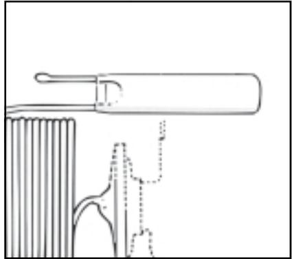
**ТРВ МОР с наполнителем** предназначены для холодильных установок, имеющих высокودинамичные испарители, например воздушных кондиционеров, или для пластинчатых теплообменников с высокой интенсивностью теплопередачи. МОР с наполнителем обеспечивает работу при перегреве на 2-4°K ниже, чем это достигается с другими типами заправки.
