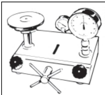
**Манометры**, предназначенные для обнаружения неисправностей и обслуживания, изготовлены на основе трубки Бёрдона (Bourdon). В системе установлены манометры такого же типа. На практике давление обычно измеряют как избыточное давление. Нулевая точка на шкале прибора означает обычное барометрическое давление, показываемое барометром. Поэтому манометр, имеющий шкалу от 1 бар (100 кПа) больше, чем 0 + максимум считывания.
