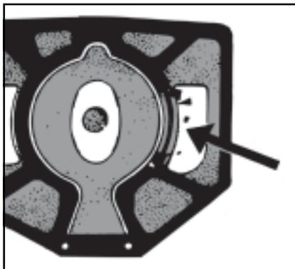
Для предотвращения коксования и омеднения мы рекомендуем устанавливать в систему качественные фильтры-осушители. Если материал фильтра будет плохого качества, продукты его износа не только частично закупорят капиллярную трубку, но и фильтр терморегулирующего вентиля, но могут повредить сам компрессор (посредством его заклинивания).
