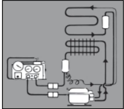
Грязь на конденсаторе и неисправность вентилятора могут привести к предельному давлению конденсации и, таким образом, уменьшить холодопроизводительность установки. В этом случае защиту компрессора от перегрузки со стороны конденсатора должно обеспечить встроенное реле высокого давления.
