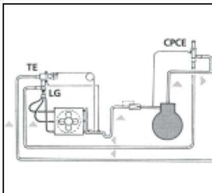
Регулятор KVC устанавливается также на байпасной магистрали, выходящей из нагнетающего трубопровода, таким образом, чтобы выход регулятора подсоединялся к контуру между ТРВ и испарителем.
