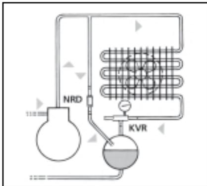
Если конденсатор с воздушным охлаждением и баллон-накопитель размещены снаружи в замороженной среде, могут появиться трудности с повторным запуском установки после продолжительной остановки.
