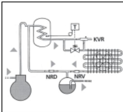
Регулятор KVR может служить запорочным вентилем в холодильных установках с автоматическим размораживанием. Тогда он монтируется на специально введенном в установку трубопроводе между всасывающей магистралью и баллоном-накопителем.
