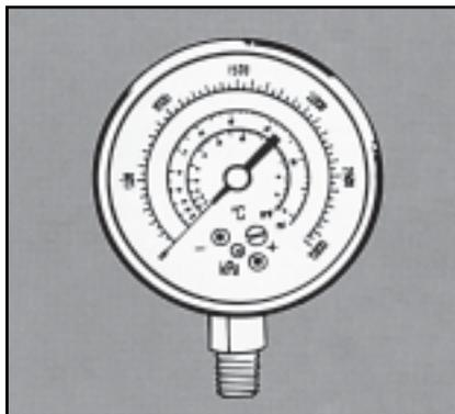
**Вакуумметры** используются в холодильной технике для измерения давления в трубопроводах в течение и после процесса вакуумирования (см. «Способы монтажа. Монтаж»). Вакуумные манометры всегда показывают абсолютное значение (нулевая точка соответствует абсолютному вакууму).
