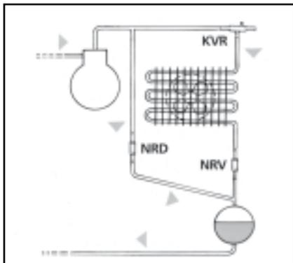
Регуляторы KVR используются также в системах с рекуперацией тепла. В этом случае регуляторы KVR устанавливаются между рекуператором и конденсатором. Чтобы избежать заброса жидкости в конденсатор, между конденсатором и баллоном-накопителем устанавливается обратный клапан NRV.
