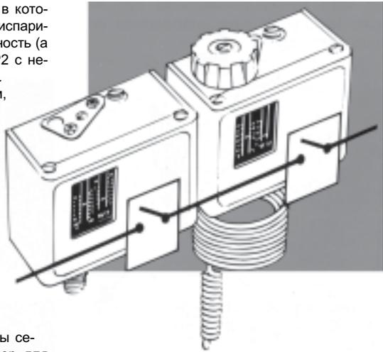
Для установок, в которых прессостаты серии КР работают очень редко (например, для выдачи сигнала тревоги) или выполняют функции датчиков-излучателей для программируемых автоматов типа HLC или им подобных, мы рекомендуем использовать **КР с золотыми пластинчатыми контактами**. Они обеспечивают надежный контакт при очень низких напряжениях.
