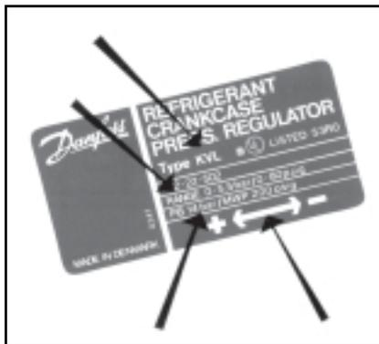
На корпусе клапанов имеется обозначение их диаметров, например, KVL 15, и стрелка, указывающая направление потока в клапане.
