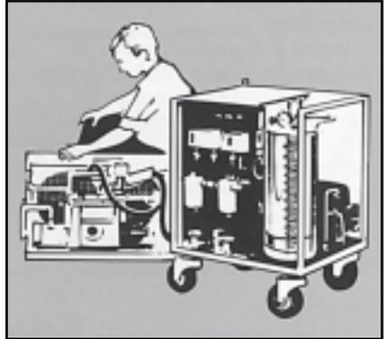
Гибкие шланги для R134a также должны иметь повышенную герметичность. При монтаже и демонтаже специальные быстроразъемные соединения обеспечивают сохранение в шлангах хладагента. Весь инструмент, используемый при техническом обслуживании установок на R134a и эфирных маслах, должен иметь соответствующую маркировку. Эту оснастку и набор принадлежностей рекомендуется использовать только для работы с R134a.
