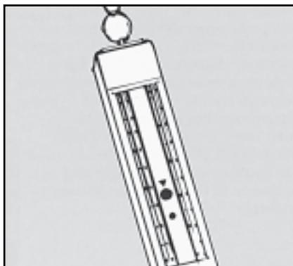
При низкой температуре и высокой влажности разница в температурах мокрого и сухого термометров становится незначительной. В этих условиях использование психрометра увеличивает погрешность, и поэтому целесообразно использование подходящего гигрометра или одного из электронных гигрометров.
