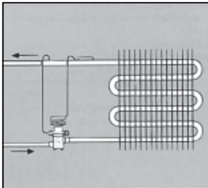
Капсулу рекомендуется устанавливать на горизонтальной части всасывающей магистрали в зоне первой трети окружности магистрали (см. рисунок). Размещение капсулы зависит от размеров всасывающей магистрали.
