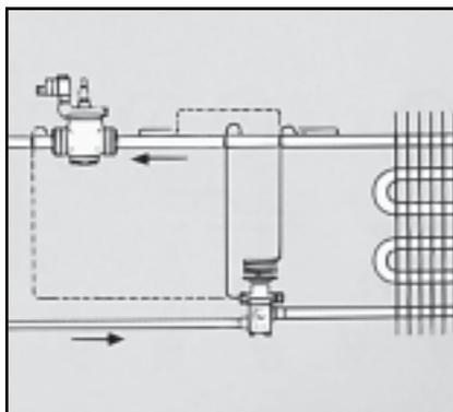
Как уже отмечалось, капсулу нужно монтировать на горизонтальном участке всасывающей магистрали сразу после испарителя. Установка капсулы на вертикальном участке или после масляной ловушки запрещена. Капсулу следует всегда монтировать выше по потоку «до петель».
