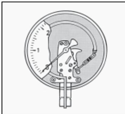
Как правило, сервисные манометры снабжены одной или несколькими шкалами для определения температуры насыщения для обычных хладагентов. Манометр должен иметь доступный винт регулировки нулевой точкой, поскольку трубка Бёрдона может просесть (become set) при длительном воздействии высокого давления.
