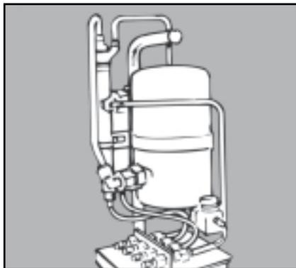
Затем нужно запустить установку на некоторое время, работая при этом на R12, и снова опорожнить ее. Таким образом следует поступить несколько раз, повторяя циклы «работа-слив-заправка R12», разделенные соответствующими промежутками времени, до тех пор, пока содержание остатков минерального масла не снизится до приемлемой величины (ниже 1%).
