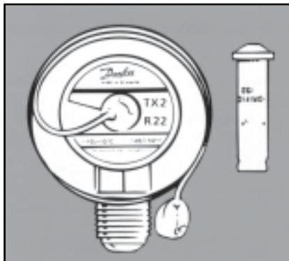
Сменные клапанные узлы маркируются, например, «02», что означает отверстие №2. Патроны для ТРВ марок TE5, TE12, TE20 маркируются на поверхности пружинной чашки.
