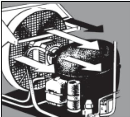
Еще одна рекомендация касается регулярности обслуживания холодильной системы, включая постоянную чистку конденсатора.
