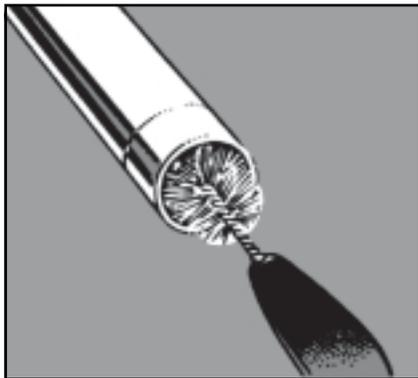
После соединения деталей намажьте тонким слоем флюса места, предназначенные для припоя. При пайке с флюсом серебряный припой может скреплять различные материалы, например, латунь и медь, железо и медь.
