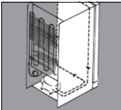
Промышленные установки должны охлаждаться при помощи вентиляторов. Рекомендуемая нормальная скорость воздуха, проходящего через конденсатор и омывающего компрессор, должна составлять 3 м/с.
