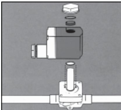
Необходимо правильно снимать крышку катушки. Возьмите крышку большим и указательным пальцами и поверните на половину оборота как при использовании гаечного ключа. Будьте осторожны! Пластиковая крышка может сломаться при перекручивании.
