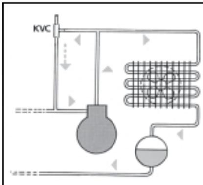
Вместо регулятора KVC может использоваться регулятор производительности CPCE. Он обеспечивает более высокую точность регулирования при низких давлениях всасывания.
