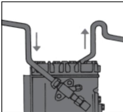
На вертикальных всасывающих трубопроводах на каждые 1,2 - 1,5 м должны быть организованы масляные ловушки (затворы). В системах с переменной во времени тепловой нагрузкой необходимо устанавливать стояки из двух труб разного диаметра.
