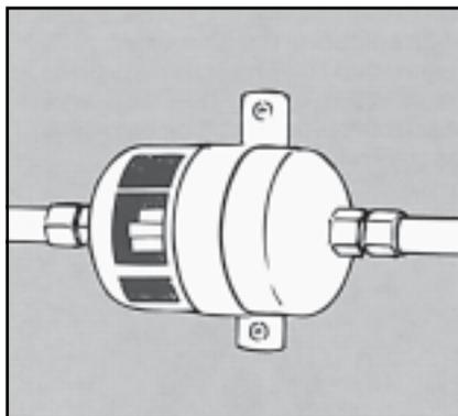
Фильтры типа DCR (с заменяемым твердым сердечником) устанавливаются таким образом, чтобы входной патрубок был направлен вверх или горизонтально. Такой монтаж позволяет легко извлекать грязь из кожуха при замене сердечника. При монтаже нового фильтра DCR предусмотрите место для удобной замены сердечника.
