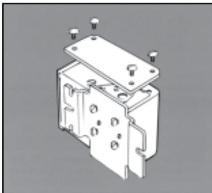
В случае установки прессостатов в сильно загрязненных или чересчур влажных помещениях (брызги воды сверху и со всех сторон) прессостаты защищаются специальными кожухами (номер кода 060-1564 - для простых моделей и 060-1565 - для сдвоенных), которые приспособлены для углового и настенного крепления.
