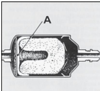
Твердый сердечник обладает большими возможностями для поглощения воды и сохранения накопленной влаги. Молекулярное сито и силиконовый гель задерживают воду, а активированная окись алюминия - воду и кислоты. Твердый сердечник В совместно с полистироловой губкой А действует так же, как фильтр от загрязнений. В твердом сердечнике накапливаются большие частицы грязи, в полистироловой губке - малые. Фильтр-осушитель способен задерживать все частицы загрязнений, размеры которых превышают 15-20 микрон.
