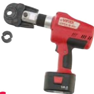
Арт. 420 Клещи электромеханические на аккумуляторе NI-CD 14,4V-2,4AH для труб до 32 диаметра. Сила сжатия 16 kN, автоматический возврат по окончании запрессовки. Лампочка-сигнализатор окончания запрессовки. Ремонт после 15.000 циклов.
