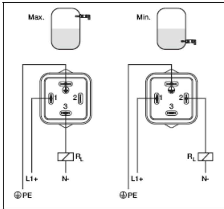
Рис. 8: Схема подключения – бесконтактный
