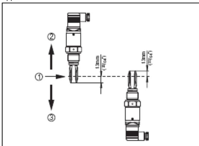
Рис. 2: Вертикальная установка
