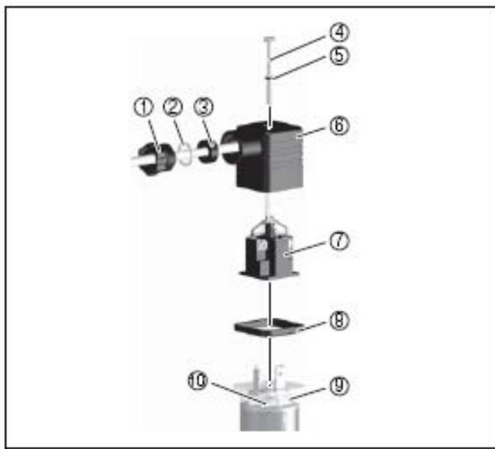
Рис. 7: подсоединение вентильного штекера DIN 43650
