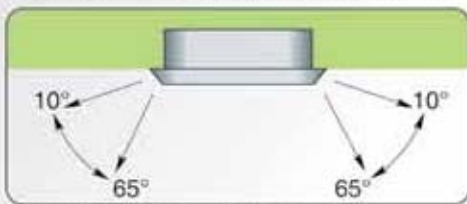
Предотвращение загрязнения потолка
