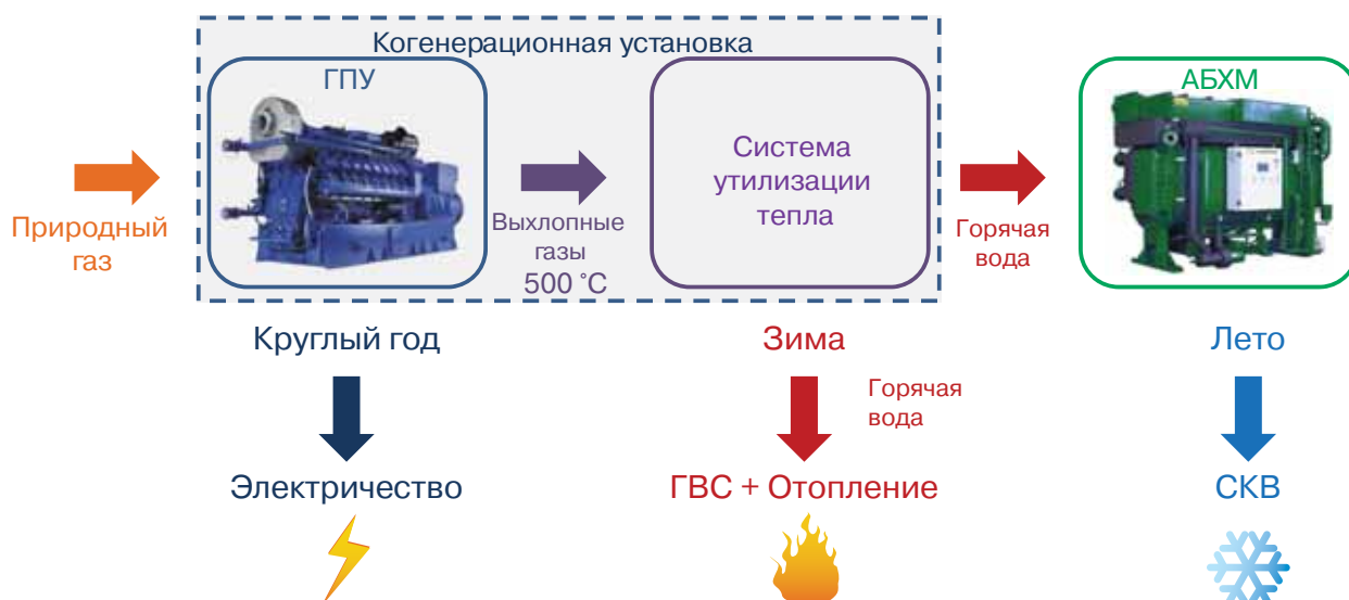
Рис. 2. Вариант применения АБХМ в системах тригенерации
