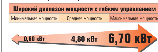
Диаграмма показывает широкий диапазон выходной мощности модели CS-XE12EKE в режиме обогрева.
