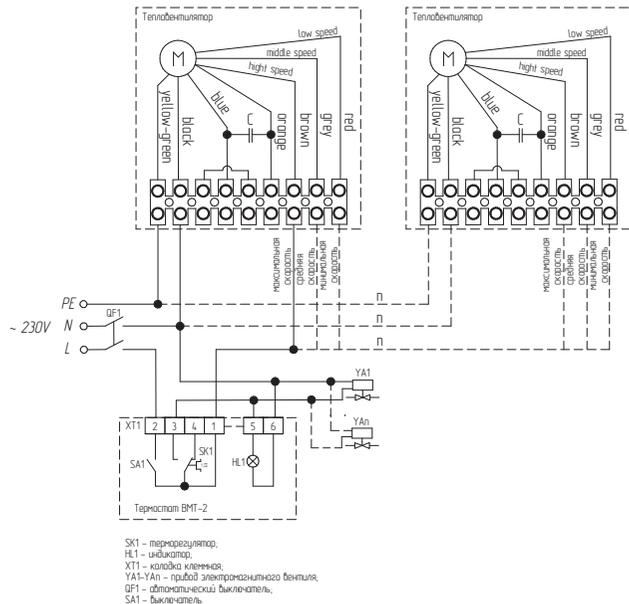
**Подключение водяного тепловентилятора к пульту BRC-W.**
