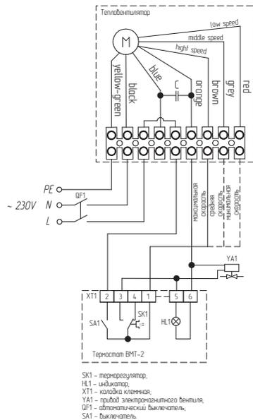
**Групповое подключение водяных тепловентиляторов к термостату ВМТ-2, осуществление регулировки температуры воздуха, подачи теплоносителя.**
