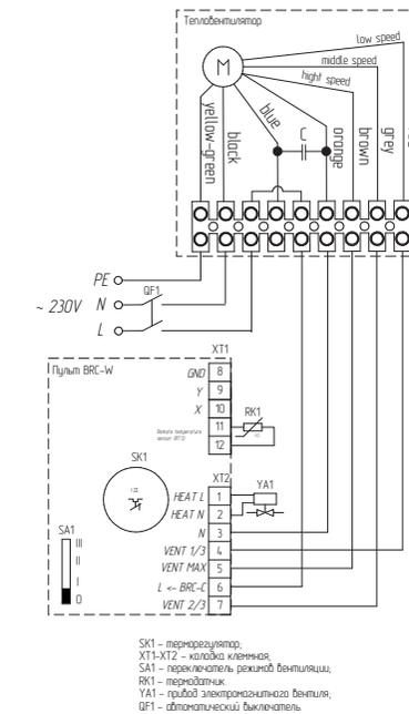
**Групповое подключение водяных тепловентиляторов к пульту BRC-W.**
