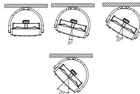
Кронштейн даёт возможность поворота теплоventilатора вокруг оси крепления на 140 градусов.
