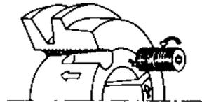
Monter l'ensemble sur l'arbre et serrer les vis alternativement et uniformément. A l'aide d'un maillet ou d'un marteau avec une cale de bois, taper la face du moyeu pour parfaire le blocage. Finir le serrage des vis à un couple de 30Nm.
