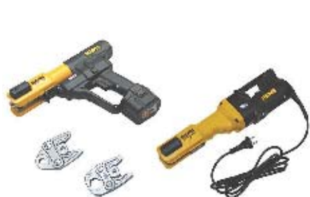
Рис. 57 Электрический пресс (аккумуляторный и с питанием от сети) для диаметров 15 - 54 мм
