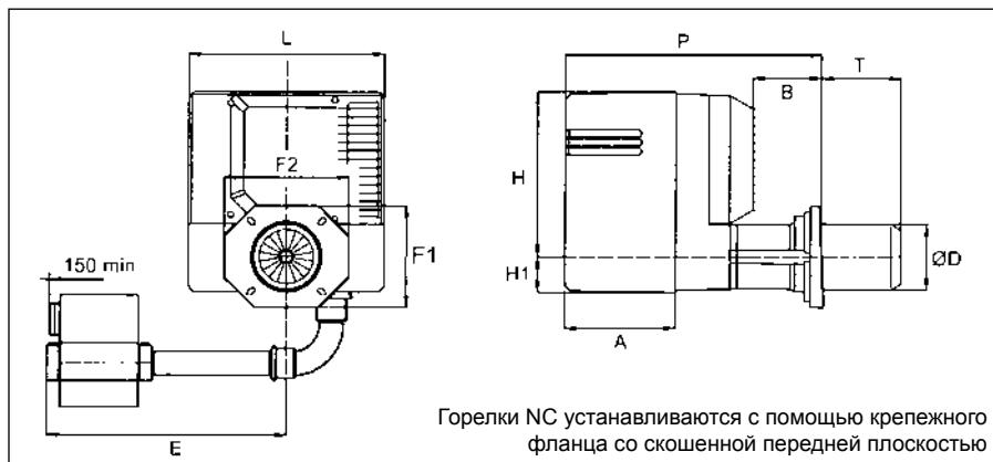
Горелки NC устанавливаются с помощью крепежного фланца со склоненной передней плоскостью
