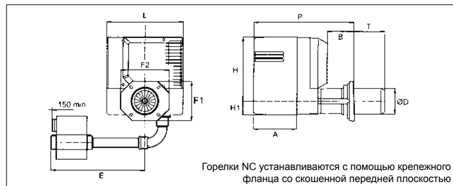
Горелки NC устанавливаются с помощью крепежного фланца со склоненной передней плоскостью
