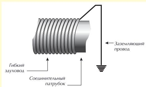
Рис. 7. Заземление
