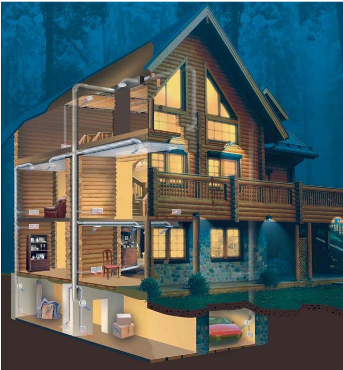
Для сравнения приведена смета (см. табл. справа) на основное оборудование и материалы для данного объекта в двух вариантах. Стандартный вариант с использованием жестяных воздуховодов и второй вариант: жестяные воздуховоды заменяются теплоизолированными гибкими воздуховодами.
