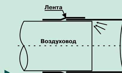
Пример использования герметизирующей ленты при соединении гибкого воздуховода с патрубком из оцинкованного железа.
