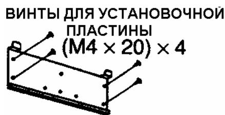
2. Слегка наклоните блок и вставьте фиксатор установочной пластины в крепежные отверстия на задней стенке воздухоочистителя.
