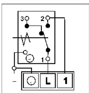
СХЕМА ПОДКЛЮЧЕНИЯ NTR 24 V
