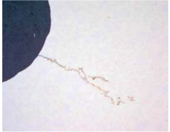
Трещина, отходящая от резьбы, вид под микроскопом
