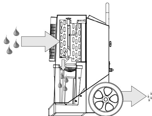
Devido à contínua circulação de ar através do desumidificador, a humidade do ar é continuamente reduzida, resultando numa secagem rápida mas suave. O desumidificador pode funcionar em contínuo, ou ser controlado por um higróstato integrado.
