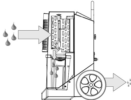
Il continuo ricircolo dell'aria nell'apparecchio, ne riduce l'umidità garantendo una deumidificazione rapida ma graduale. Il deumidificatore può funzionare in modo costante, oppure essere controllato da un igrostat integrato.
