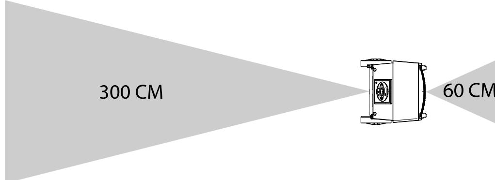
**Funzionamento ottimale** - Accertarsi che l'ambiente da deumidificare sia chiuso, e che la macchina non si trovi vicino a una fonte di calore, per esempio un radiatore.
