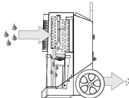
По мере того как воздух циркулирует через осушитель, его влажность постепенно снижается, что приводит к быстрому, но мягкому осушению. Осушитель может работать непрерывно или включаться и выключаться встроенным гигростатом.
