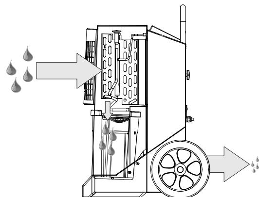
Pri opakovanom priechode vzduchu odvlhčovačom sa opakovane znižuje jeho obsah vlhkosti, a tým sa vzduch rýchlo, ale miernym spôsobom vysušuje. Odvlhčovač je možné prevádzkovať sústavne, alebo ho ovládať integrovaným hygrostatom.
