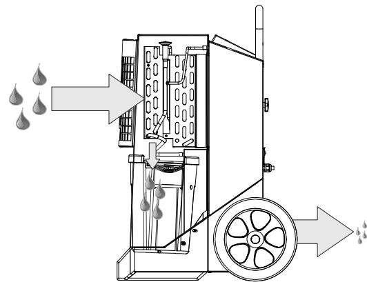
La circulation répétée de l'air dans le déshumidificateur fait constamment diminuer sa teneur en humidité et produit une déshumidification rapide mais en douceur. Le déshumidificateur peut fonctionner continuellement ou être contrôlé par un hygrostat intégré.
