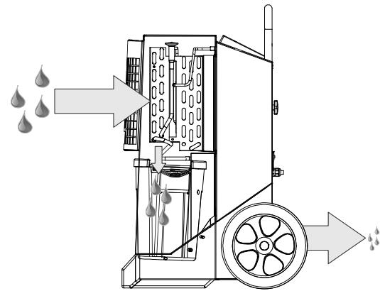
Dadurch, dass die Luft wiederholt durch den Entfeuchter strömt, wird die Luftfeuchtigkeit ständig reduziert. So ist eine schnelle, schonende Trocknung möglich. Der Entfeuchter kann ununterbrochen laufen oder durch einen eingebauten Hygrostaten gesteuert werden.
