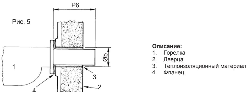
Смотреть параграф: Технические данные по длине форсунки (P6), диаметру отверстия горелки ( $\text{Ø}b$ ) и герметизации.
