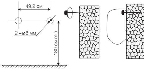
Мал.3. Схема установки приладу
