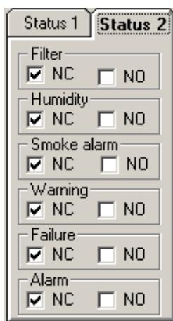
С помощью данной панели можно настроить работу платы управления кондиционера в зависимости от типа контакта сигнала подсоединяемого optionalного компонента:
