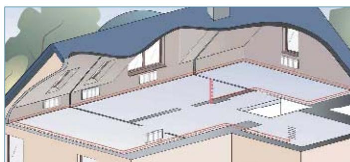
**Рис. 84** Двухтрубная разводка в горизонтальной петле в системе отопления
