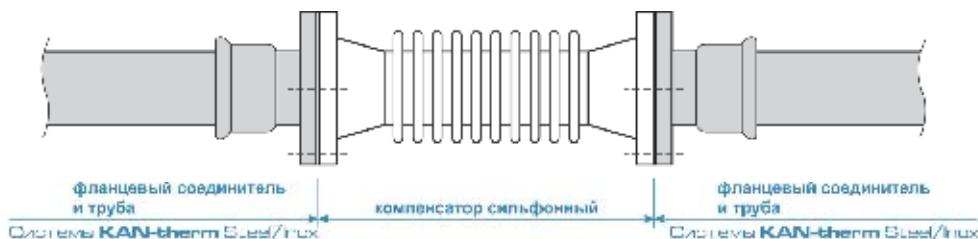
Рис. 75 Компенсатор сильфонный для стальных труб (пример)
