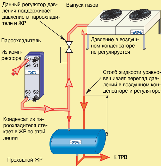
Рис. 11А. Отвод конденсата из пароохладителя
