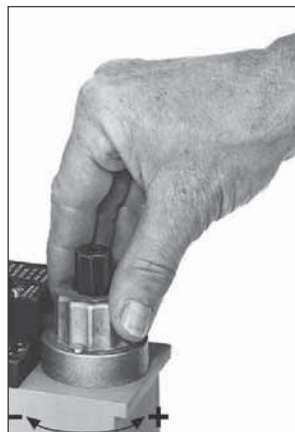
Рис.15 Регулировка главного потока MB- ... B01
