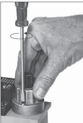
Рис.15 Регулировка главного потока MB- ... B01
