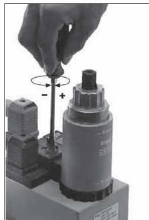
Рис.14 Регулировка динамического давления газа MB- ZR ... B01
