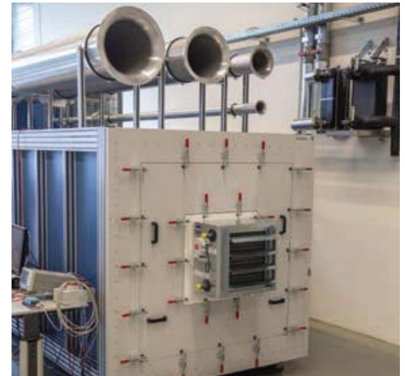
Проведение испытаний по измерению мощности воздуха в соответствии с EN ISO 3745 (ранее - DIN 24163); Научно-исследовательский центр Kampran
