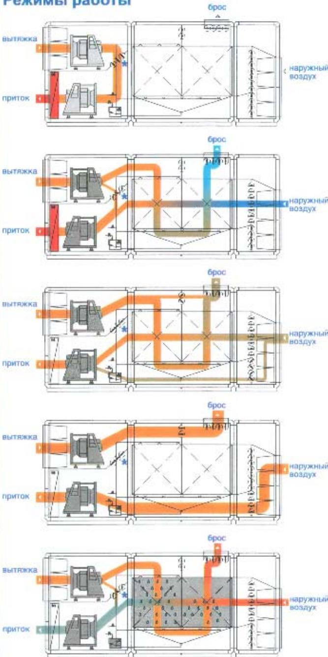
1 Нагревание воздуха в рециркуляционном режиме с помощью регистра, по которому циркулирует горячая вода.
