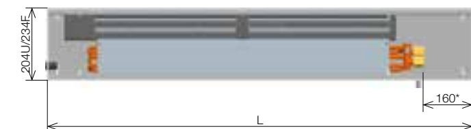
* Примерное расстояние для подключения у всех производимых размеров PKIOC 11/20 является 160 мм.
