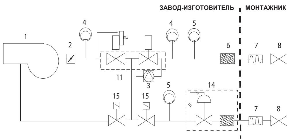
Газовая рампа 2 (2"): Газовая рампа с группой клапанов MBC SE 1200 (2 клапана + газовый фильтр + стабилизатор давления) + блок контроля герметичности VPS504 и рампа запальной горелки
