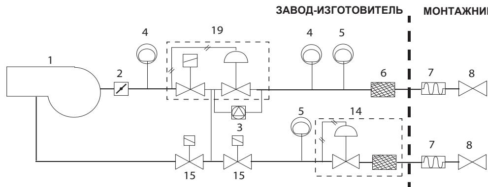
Газовая рампа 4 (DN100): Газовая рампа с группой клапанов MBC SE 1900/3100/5000(2 клапана + газовый фильтр + стабилизатор давления) + Реле давления газа для контроля за утечками + рампа запальной горелки
