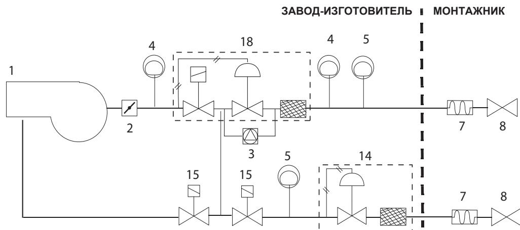
Газовая рампа 3 (DN65/80/100): Газовая рампа с группой клапанов MBC SE 1900/3100/5000(2 клапана + газовый фильтр + стабилизатор давления) + блок контроля герметичности VPS504 и рампа запальной горелки
