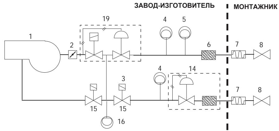
Газовая рампа 4 (DN125): Газовая рампа с группой клапанов VGD40 (2 клапана + газовый фильтр + стабилизатор давления) + Реле давления газа для контроля за утечками + рампа запальной горелки
