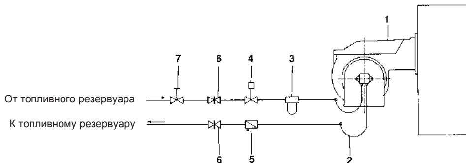
Рис. 17 - Двухтрубная система
