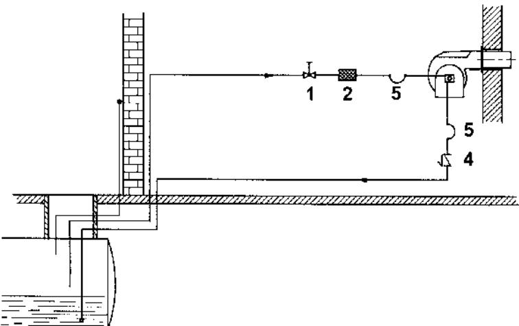
**ПРИМЕЧАНИЕ:** в системах с гравитационной подачей или с кольцевым контуром, установить автоматическое отсечное устройство (см. № 4 - Рис. 17).
