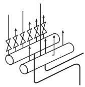
Нельзя устанавливать какие-либо вентили на труbe обратной воды и отопительной трубе горячей воды. Если Вы устанавливаете вентиль, следует установить распределитель и затем вентиль таким образом, чтобы можно было по необходимости им пользоваться. Будьте осторожны, если все вентили закрыты, возможны случаи деформации, вызванные избыточным давлением теплообменника или действием предохранительного клапана из-за избыточного давления в отопительном котле.
