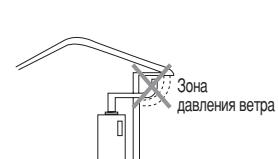
Если установить в зоне давления ветра, это может привести к образованию сажи из-за неполного сгорания, снижению коэффициента полезного действия, аварийным остановкам. Рекомендуется установить дымовую трубу вне зоны давления ветра, т.к. в ином случае невозможна нормальная работа отопительного котла.
