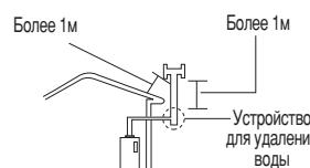
Рекомендуется устанавливать таким образом, чтобы избежать зоны давления ветра в верхней части дымовой трубы, защитить трубу от дождя и ветра.
