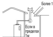
Если в пределах 1м от дымовой трубы находится высокое здание или другое сооружение, рекомендуется устанавливать дымовую трубу выше более 1м от крыши высокого здания.
