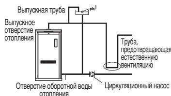
Для предотвращения естественной циркуляции, вызываемой конвекционным действием, при прокладке отопительных труб горячей воды рекомендуется установить трубу, предотвращающую естественную циркуляцию. При прокладке труб отопления используйте предохранительное выпускное отверстие и выпускное отверстие отопления, которые позволяют предотвратить разрушение отопительного котла вследствие расширительного давления.
