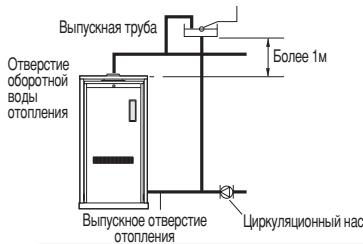
Рекомендуется установить расширительный бак на высоте более 1м от верхней части отопительного котла (при установке в подземном помещении установите на высоте более 1м от высоты прокладки труб на полу помещения)
