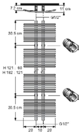
> ВАРИАНТЫ ПОДКЛЮЧЕНИЯ > EXEMPLES DE RACCORDEMENT
