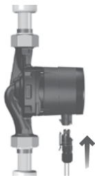
Рис. 10 Подключение к электросети
