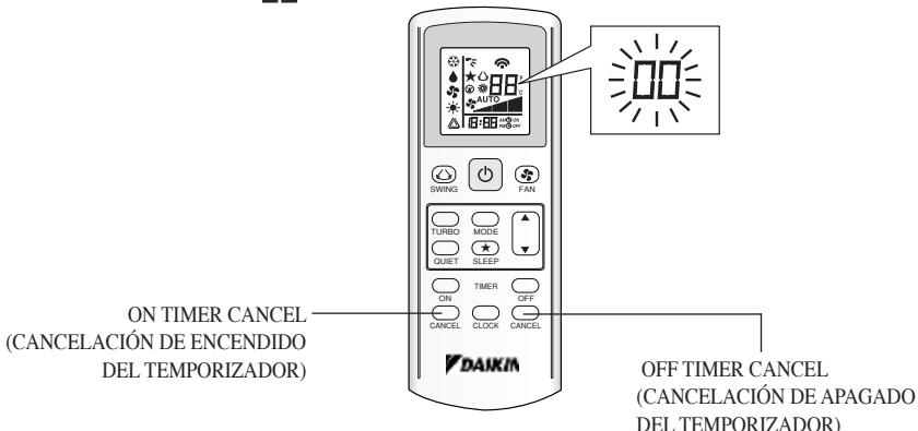
2. Presione el botón de ON TIMER CANCEL (CANCELACIÓN DE ENCENDIDO DEL TEMPORIZADOR) o el botón OFF TIMER CANCEL (CANCELACIÓN DE APAGADO DEL TEMPORIZADOR) repetidamente hasta que se produzca un pitido continuo.
