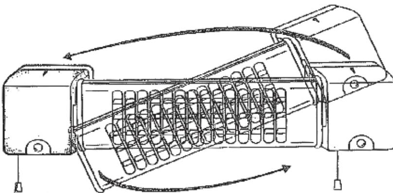
Если блок управления необходимо расположить с левой стороны, переключающий элемент должен быть вынут из посадочного места при помощи отвертки, развернут на 180° и установлен на новое посадочное место, соответствующее левому расположению блока управления. Убедитесь в том, что переключающий элемент был четко зафиксирован зажимами в месте посадки.
