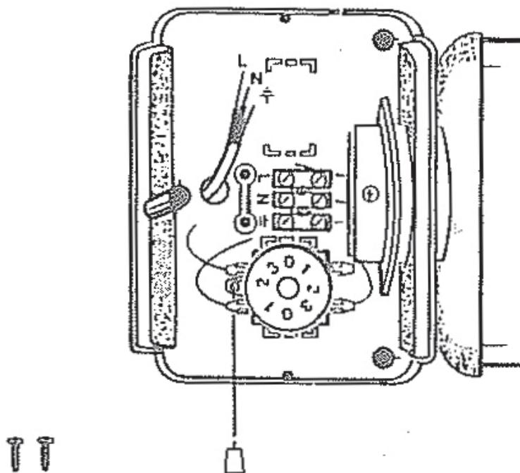
Закрепите крышку блока управления (**C**) с индикаторным окошком (**B**) над красным колесом-переключателем и закрутите крепежные винты обратно.
