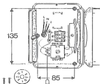
Просверлите отверстия и прикрепите прибор к стене при помощи винтов и дюбелей, входящих в комплект поставки.
