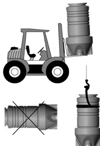
Рис. 10 Способы подъема/транспортировки колодца
