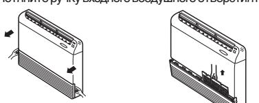
(Если установлен дезодорирующий фильтр или фильтр очистки воздуха (ОПЦИОНАЛЬНО), пожалуйста снимите его перед тем, как производить чистку воздушного фильтра.)
