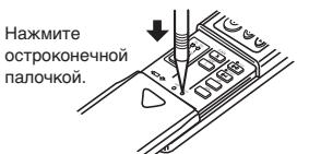
**4 Нажатием кнопок TIME SET (установки времени) HR. (часы) и MIN. (минуты) установите текущее время.**
