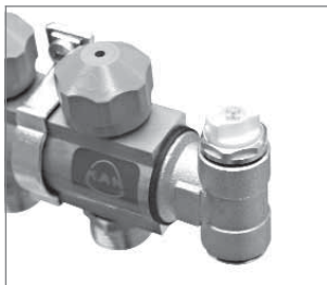
Распределитель 51А, 55А, 71А, 75А с тройником (R542), заглушкой G½" (6095.34) и ручным воздуховыпускным клапаном (5322).
