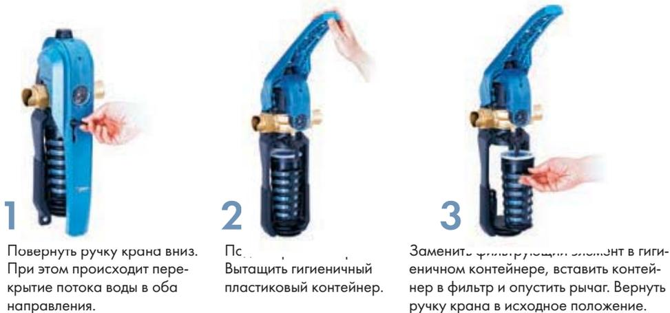
Такая система минимизирует риски загрязнения фильтрующего элемента при замене, так как нет необходимости прикасаться к деталям, контактирующим с водой.
