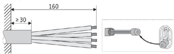
» Připravte přívodní elektrický kabel.
