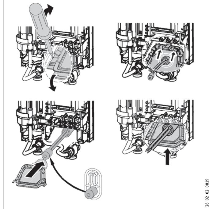
Cuando se utilizan secciones transversales de cable grandes, el manguito para cables puede montarse posteriormente al montaje del equipo. Para ello debe realizar los siguientes pasos:
