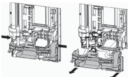
» Presione los dos ganchos de enclavamiento derecho e izquierdo y tire de la parte inferior hacia delante.
