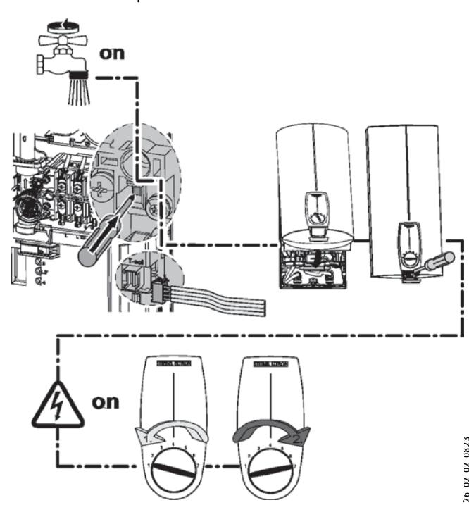
» Několikrát otevřete a zavřete všechny připojené ventily v odběrných místech. Dělejte to tak dlouho, dokud nedojde k odvzdušnění rozvodné sítě a přístroje.
