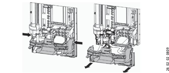
» Drücken Sie die beiden Rasthaken rechts und links und ziehen Sie das Unterteil nach vorne ab.
