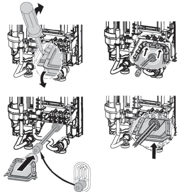
Bei Verwendung von großen Leitungsquerschnitten kann die Kabeltülle nach der Montage des Gerätes montiert werden. Dafür müssen Sie folgende Schritte vornehmen:
