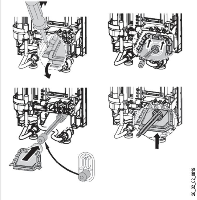
При использовании проводов с большим поперечным сечением насадку кабеля можно установить после монтажа прибора. Для этого нужно выполнить следующие действия:
