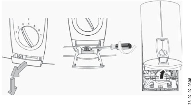
Zur Einhaltung des Berührungsschutzes im Auslieferungszustand ist bei einigen Varianten im Bedienteil ein Pappstreifen eingelegt. Entfernen Sie diesen Streifen vor der Gerätemontage.
