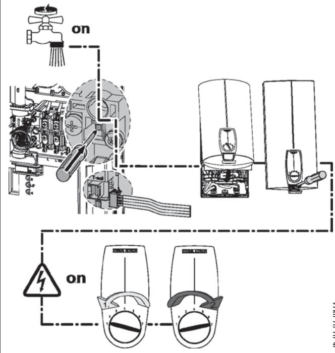
» Kilkakrotnie zamknąć i otworzyć wszystkie podłączone zawory czerpalne. Robić to tak długo, aż całe powietrze zostanie usunięte z sieci przewodów i urządzenia.
