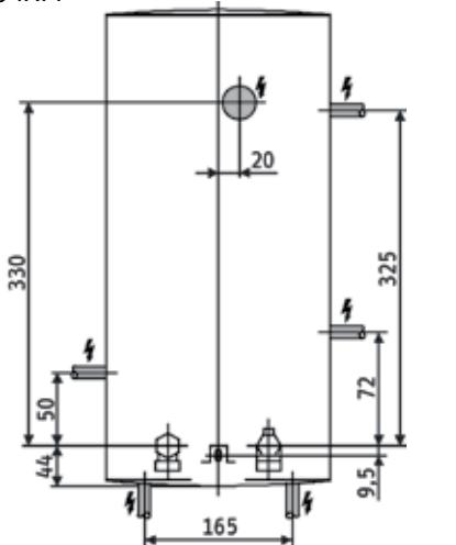
» W razie potrzeby wyciąć lub wyłamać przepusty w ścianie tylnej i w osłonie urządzenia. Dopuszczalne miejsca wyłomu przedstawiono na rysunku „Wymiary dla przyłącza elektrycznego”.
