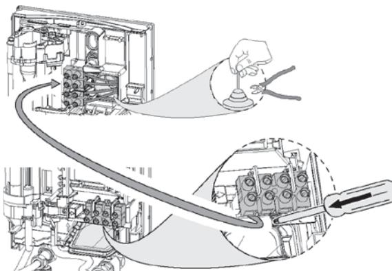
W przypadku użycia przewodów o dużej średnicy, tulejkę kablową można zamontować po montażu urządzenia. W tym celu należy wykonać następujące czynności:
