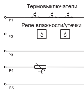
Рис. 22 Исполнение с датчиками 1
