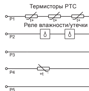
Рис. 23 Исполнение с датчиками 1 (PTC)
