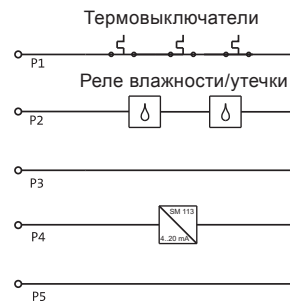
Рис. 25 Исполнение с датчиками 2 (термовыключатели) и взрывозащищенное исполнение 2
