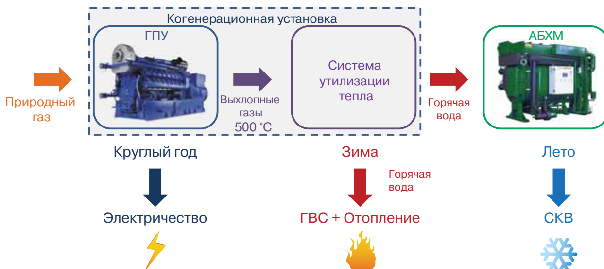
Рис. 2. Вариант применения АБХМ в системах тригенерации
