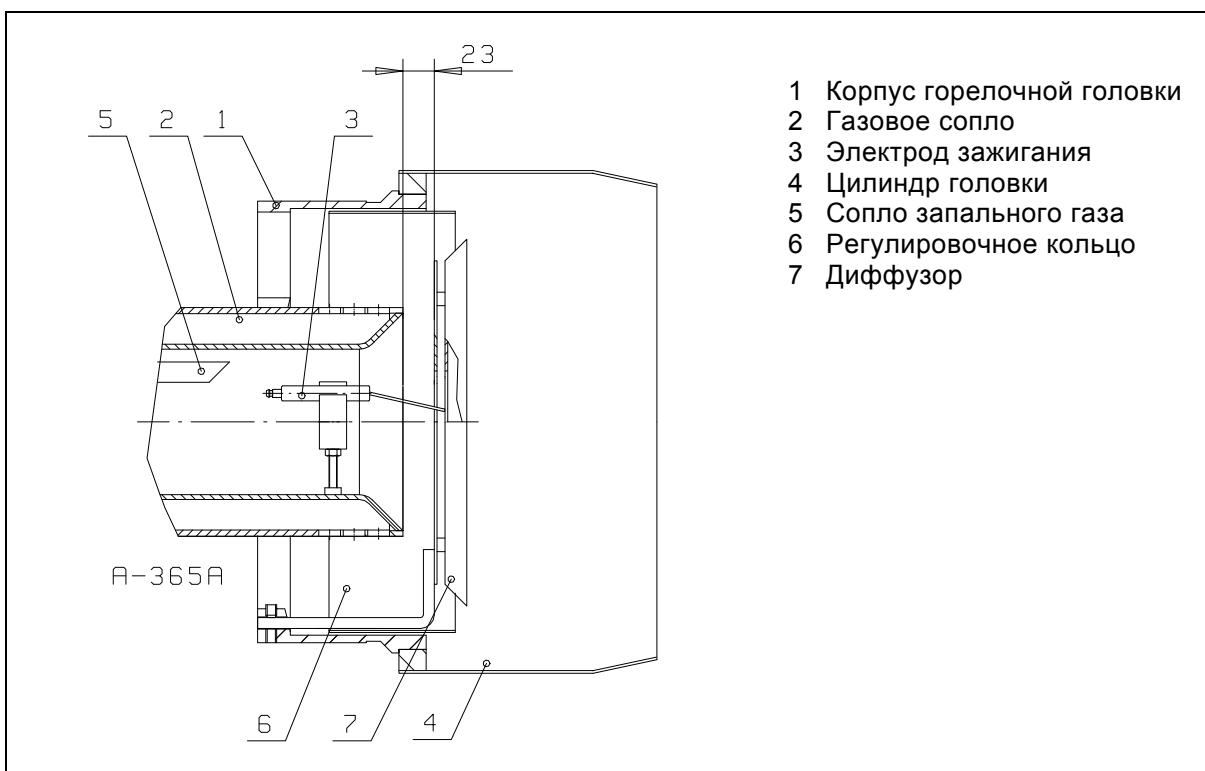
Размер 23 мм в рисунке означает расстояние торца газового сопла от задней поверхности диффузора.
