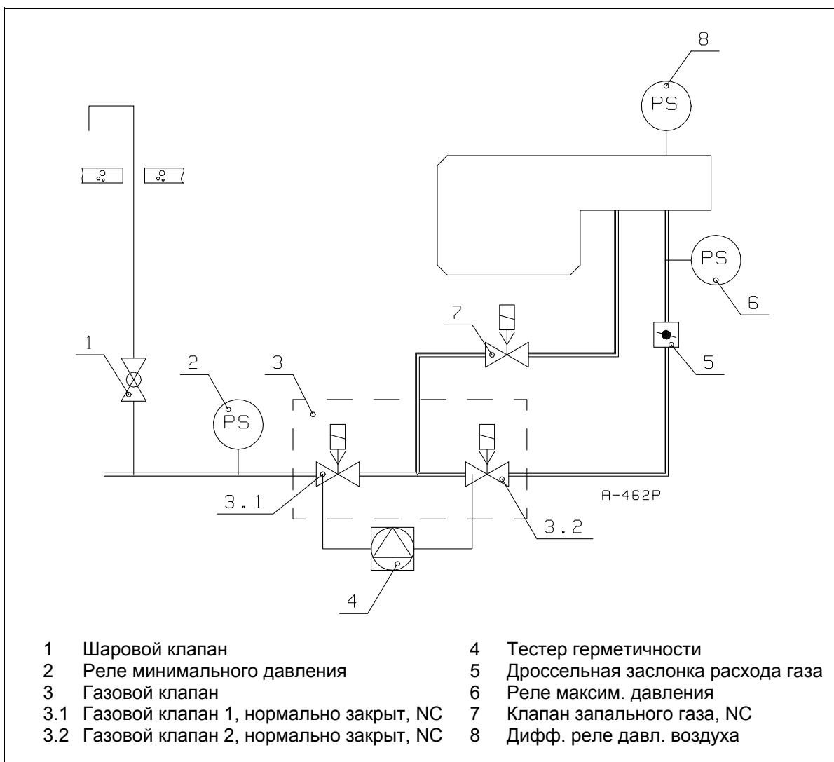
Предварительная продувка производится с объемом воздуха полной мощности. При этом клапаны (3.1), (3.2) и (7) закрыты.
