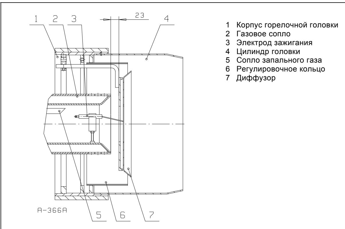
Размер 23 мм в рисунке означает расстояние торца газового сопла от задней поверхности диффузора.
