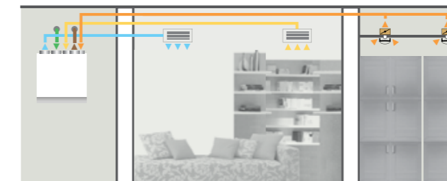
С отдельно подключенными дополнительными диффузорами вытяжного воздуха
