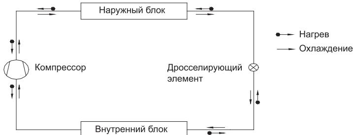
Рисунок 4.2 – Схема работы кондиционера
