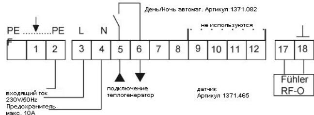
Датчик подключается к контактам 17 и 18. Питание теплогенератора и подводящие провода датчика всегда должны быть разделены путем использования разных отверстий в корпусе. Подводящие ПРОВОДА датчика проложены через внешнее правое отверстие. Они могут быть удлинены до 50м. Для этого должен использоваться экранированный кабель типа LiYCY 2 x 0.5. Экран должен быть установлен с одной стороны на контакте 18.
