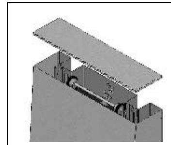
Для удобства транспортировки противовес топок, работающих при открытой дверце, заблокирован. Для проверки исправности противовеса необходимо его разблокировать.
