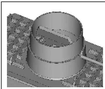
Механизм регулировки тяговой заслонки: открытое положение
