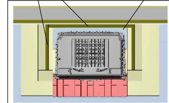
Защита перегородки из негорючих материалов теплоизоляционным материалом класса А1 или не менее А2 s1 d0.
