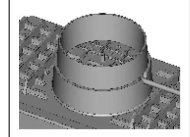
Механизм регулировки тяговой заслонки: закрытое положение
