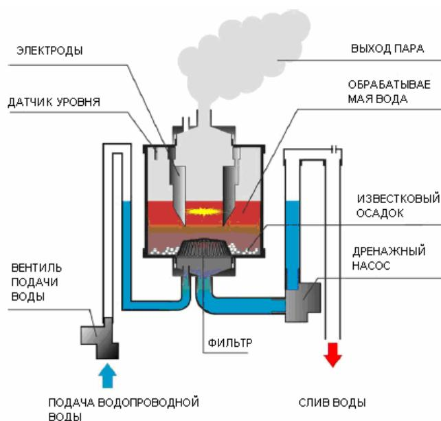
Для генерирования пара в увлажнителях используется водопроводная вода. Электроды цилиндра погружены в воду, между электродами протекает ток, который нагревает воду до точки кипения. Сила тока и, соответственно, выход пара изменяется в зависимости уровня воды в цилиндре. Контроллер измеряет потребляемый ток и регулирует уровень воды в цилиндре, добавляя воду в цилиндр с помощью клапана для подачи воды или откачивая излишек дренажным насосом.
