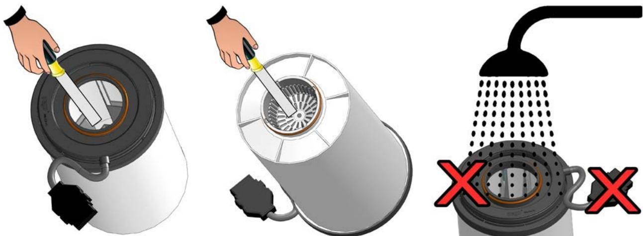
4. Проверьте состояние уплотнительных колец, при необходимости замените.
