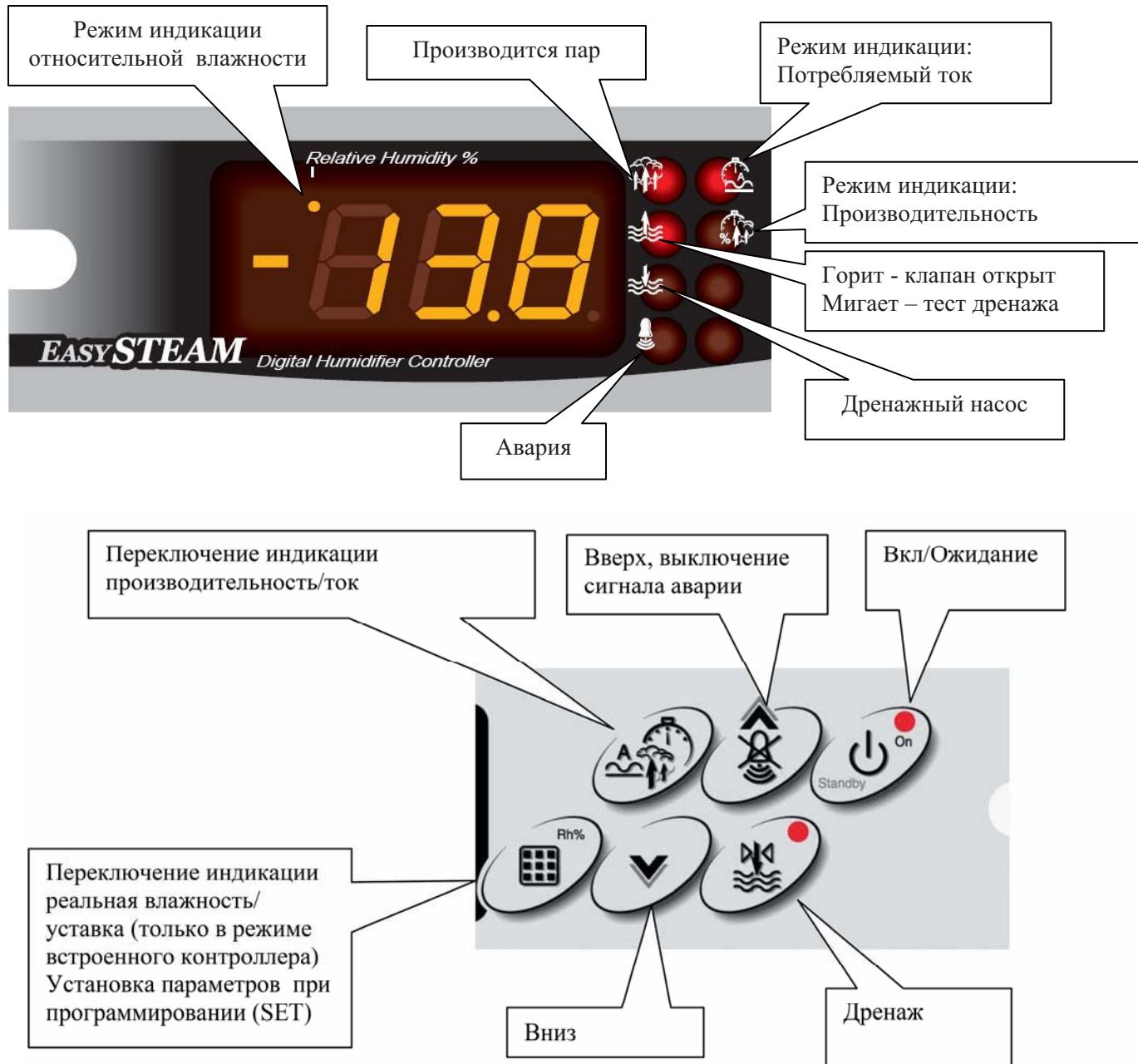
При подаче напряжения питания увлажнитель переходит в режим ожидания, при этом мигает индикатор кнопки «Вкл/Ожидание». Если увлажнитель останавливался из-за отключения электропитания, то при возобновлении подачи электропитания увлажнитель продолжит работу.
