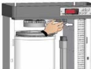
5. Поднимите цилиндр немного вверх и выньте его из нижнего фланца, а затем извлеките его из увлажнителя.
