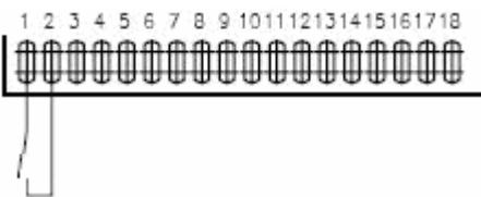
При разомкнутом контакте увлажнитель не работает и на дисплее горит **OFF**.
