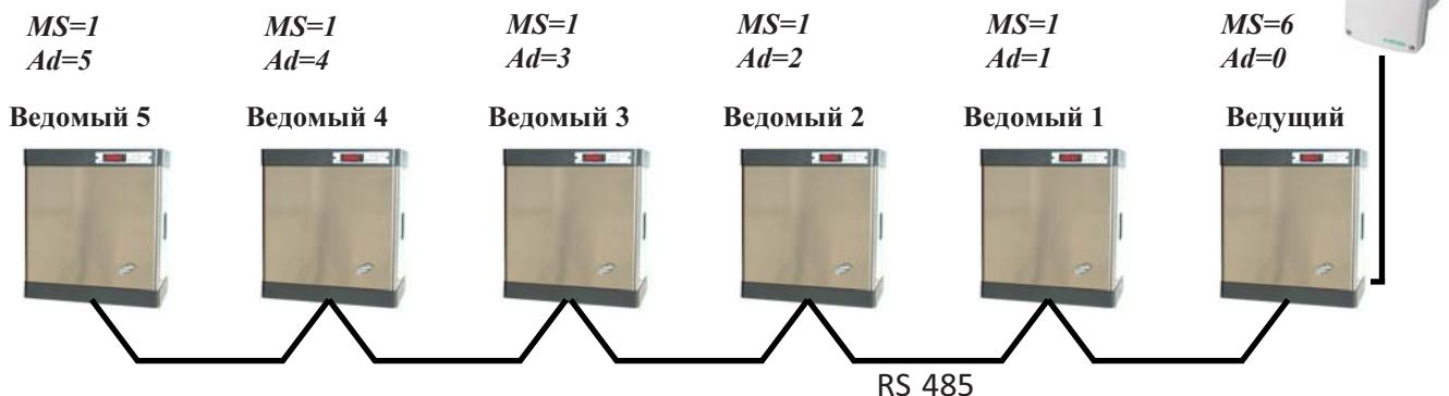
Для работы в системе «ведущий-ведомый» у каждого увлажнителя должны быть установлены параметры MS и Ad. Если увлажнитель отключен от системы «ведущий-ведомый» и используется самостоятельно установите параметры MS 0 и Ad 0. Параметры устанавливаются на втором уровне программирования, см. описание модуля управления.
