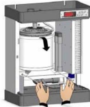
2. Снимите задний зажим с верхнего фланца и опустите его.
