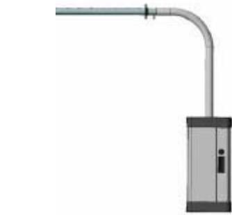
Если парораспределительная трубка расположена выше увлажнителя, трубка и паровой шланг не имеют препятствий для свободного слива конденсата обратно в цилиндр - шланг для удаления конденсата можно не устанавливать. Патрубки для конденсата на цилиндре и парораспределительной трубке должны быть заглушены.
