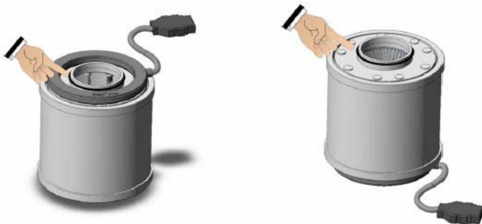
**ПРИ ПОМОЩИ КНОПКИ «ДРЕНАЖ» ПРОМОЙТЕ ЦИЛИНДР 2-3 РАЗА СРАЗУ ПОСЛЕ ТОГО, КАК ВСТАВИТЕ ЕГО В УВЛАЖНИТЕЛЬ.
