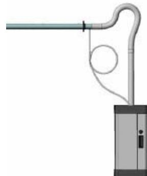
Если парораспределительная трубка расположена выше увлажнителя, но слив конденсата из части парового шланга возможен только обратно в парораспределительную трубку - необходимо установить шланг для удаления конденсата. Шланг присоединяется к соответствующим патрубкам на цилиндре и трубке, на шланге для конденсата необходимо сделать петлю минимальным диаметром 200 мм, перед использованием петлю следует заполнить водой.
