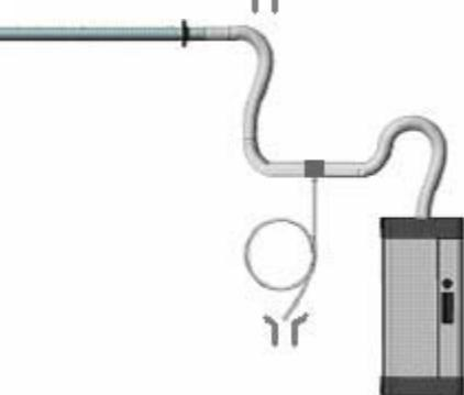
Если слив конденсата из части парового шланга невозможен, в самой нижней точке необходимо установить тройник с патрубком для подключения шланга для конденсата, на шланге для конденсата необходимо сделать петлю минимальным диаметром 200 мм, перед использованием петлю следует заполнить водой. В зависимости от высоты расположения тройника конденсат можно возвращать в цилиндр, либо сливать в канализацию.
