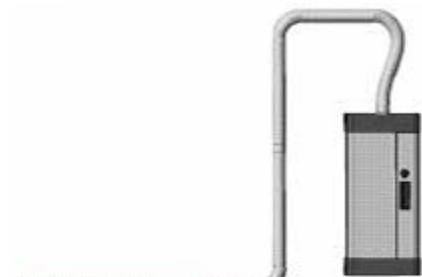
Если парораспределительная трубка расположена ниже увлажнителя - конденсат следует сливать непосредственно в канализацию, на шланге для конденсата необходимо сделать петлю минимальным диаметром 200 мм, перед использованием петлю следует заполнить водой.
