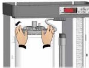
3. Поднимите фланец, вынимая его из цилиндра.
